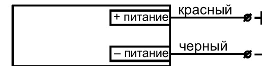
Рис.3. Схема подключения излучателя МикРА Ф5И.
